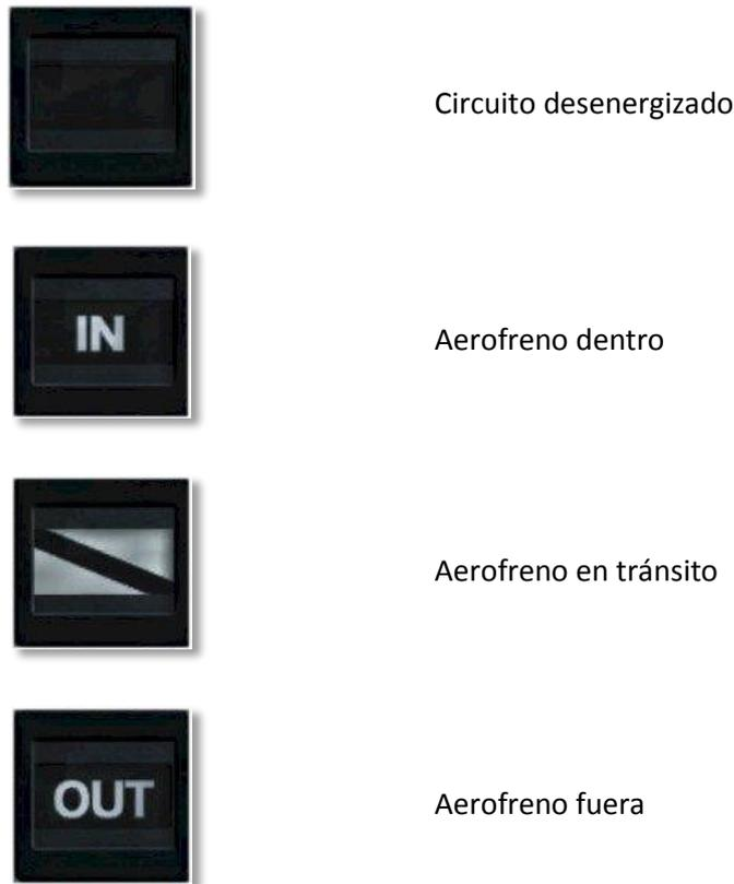
Figura 3-44 Indicadores de posición del aerofreno
