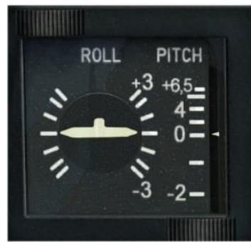
Figura 3-41 Indicador de posición de compensadores
