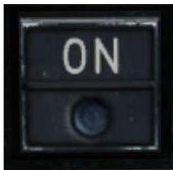
Figura 3-49 Pulsador Korry de calefacción de pitot
