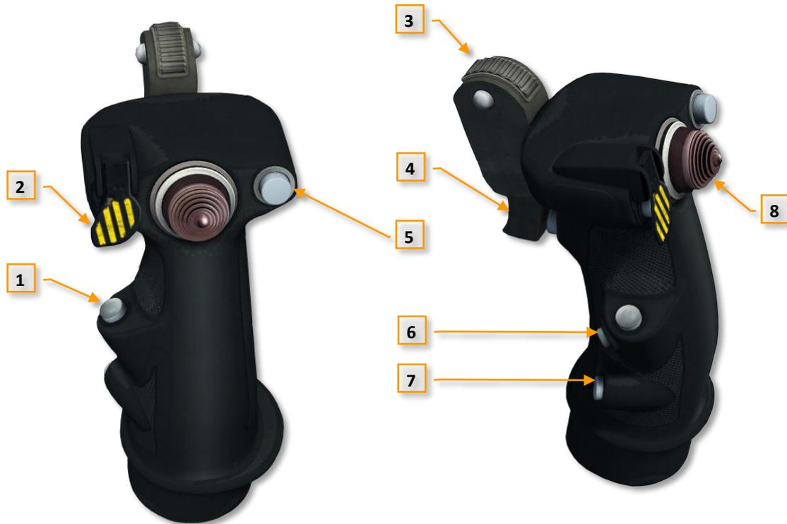
Figura 3-42 Empuñadura de la palanca de mando
