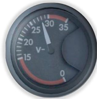
*Figura 3-32 Voltímetro de CC*
