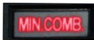
Figura 3-27 Luz de aviso de bajo nivel de combustible
