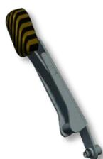
Figura 3-62 Palanca de suelta de cúpula
