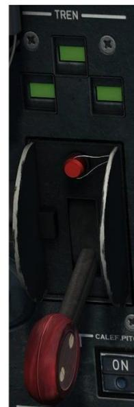
Figura 3-46 Palanca del tren
