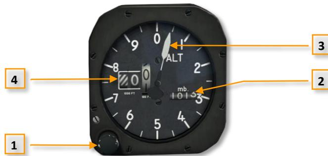
Figura 3-54 Altímetro con codificador de altitud
