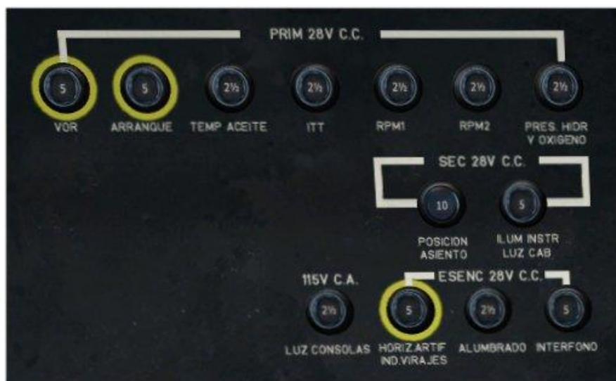
Figura 3-36 Panel de cortacircuitos de la cabina trasera
