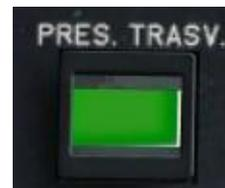
Figura 3-22 Luz de aviso de baja presión/Indicador de presión de transferencia
