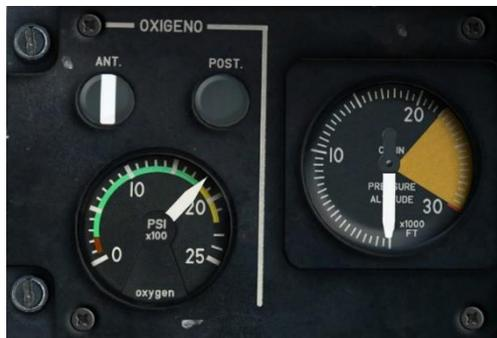
Figura 3-67 Panel de oxígeno y altímetro de cabina
