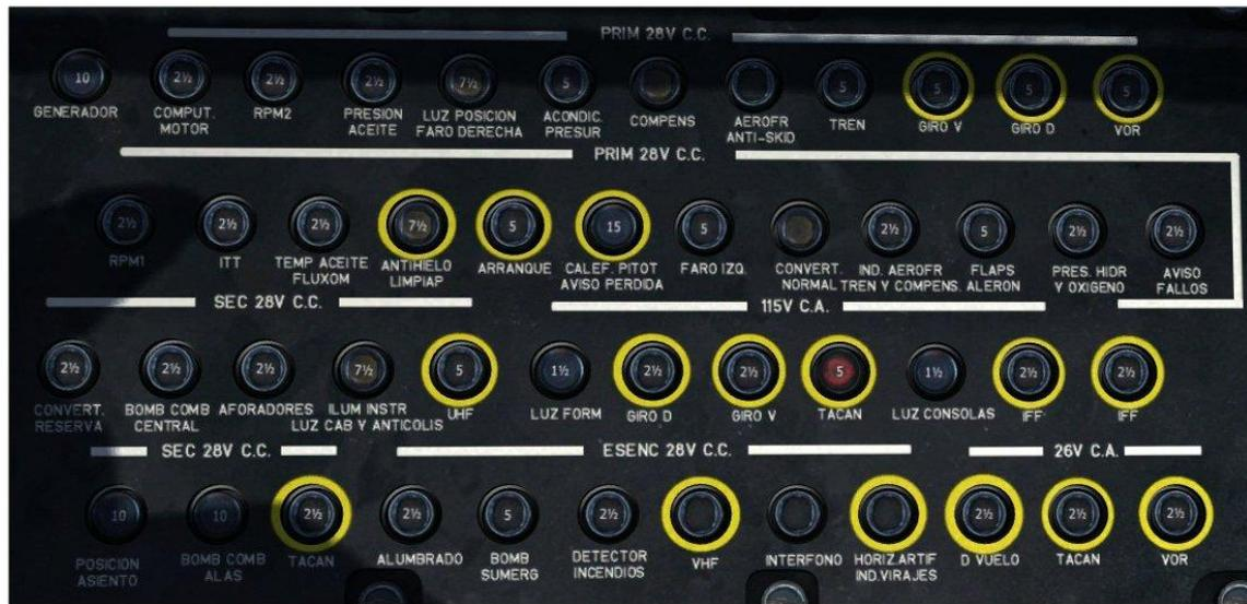
Figura 3-35 Panel de cortacircuitos de la cabina delantera
