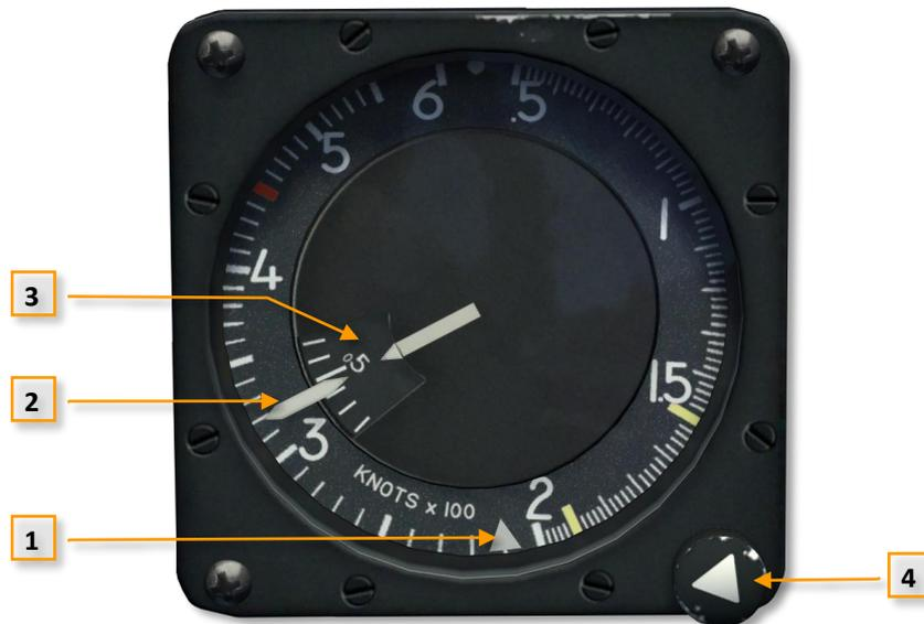
Figura 3-50 Anemómetro y máchmetro
