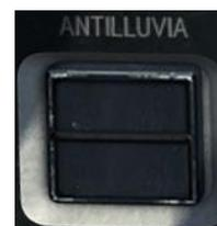
Figura 3-66 Korry del repelente de lluvia
